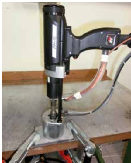
Bild 4 • SRM-Schweißpistole für M16-Bolzen – der Anschluss der Magnetfeld-Schutzgasvorrichtung an die Stützfüße von Schweißpistolen und Schweißköpfen ist auch bei stationärer Handhabung einfach möglich.
