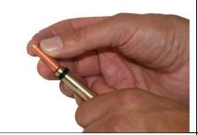
Insert weld stud into stud chuck.
