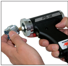
Kontaktschweißpistole PS-1K mit Schnellwechselsystem für Pistolenstützrohre
